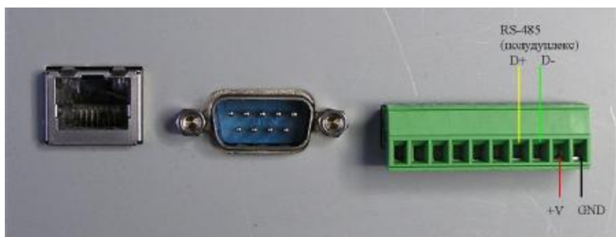
Рис 6.а Подключение к интерфейсу RS-485 терминала DK-9000
