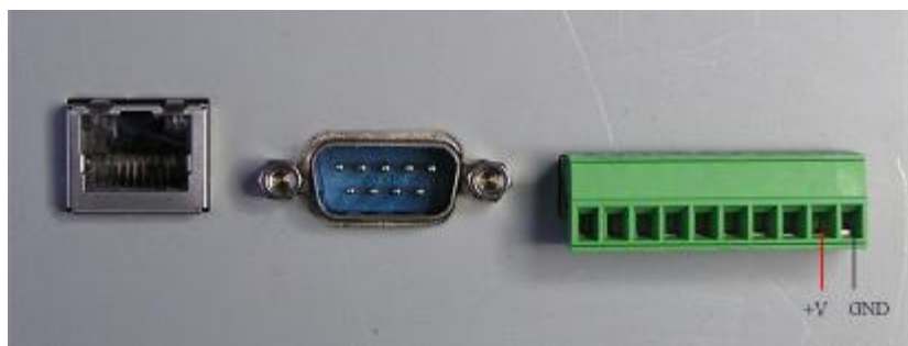
Рис. 4 Подключение источника питания к терминалу DK-9000(E)
